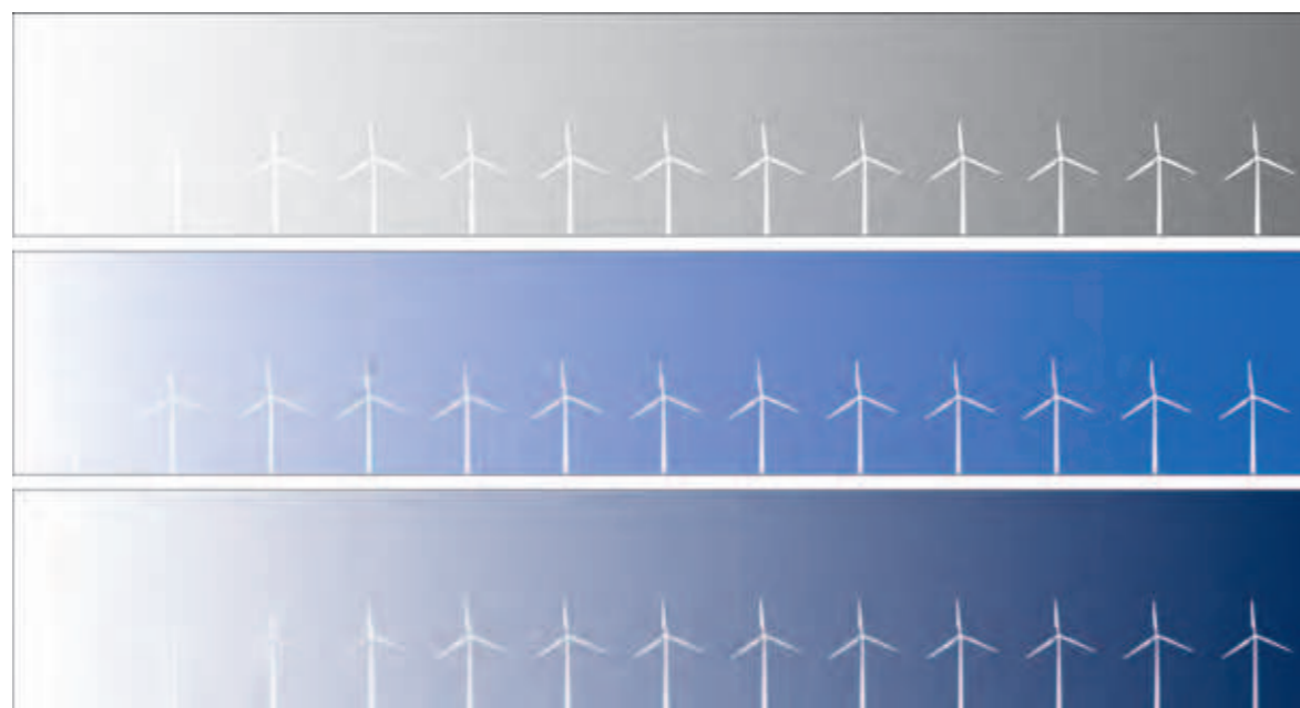
Figure 22 : Simulation d'éclairage des éoliennes en fonction de la couleur du ciel (Source : ENCIS Environnement, d'après un document d'Abies, Guide de l'étude d'impact sur l'environnement des parcs éoliens, 2005).
